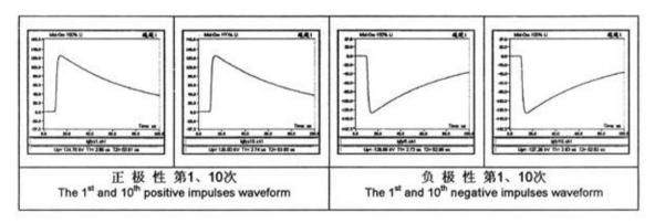
附录C 恒压负荷循环试验后组合试样冲击电压试验实际耐受电压值和冲击电压波形(室温下,125 kV,允许 ±3%偏差)
